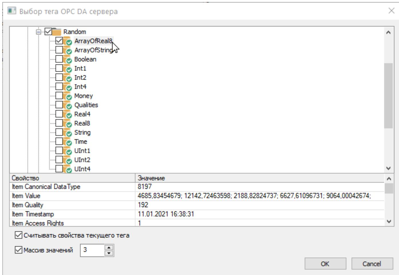
**Рисунок 3.13. Значения из массива, отображаемые как подтеги OPC**
