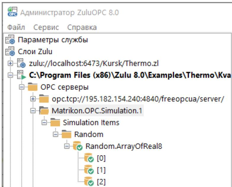
**Рисунок 3.12. Значения из массива, отображаемые как подтеги OPC**
