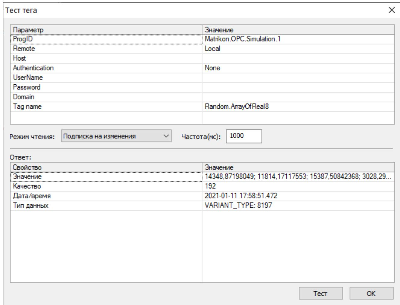
Рисунок 3.14. Значения из массива, отображаемые как подтеги OPC
